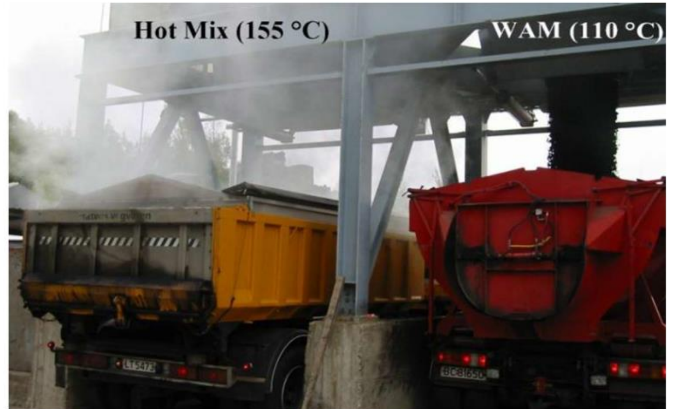
Bilde 3.1: Fra tidlige forsøk med WAM-Foam. Mengden bitumenrøyk er vesentlig redusert ved masse-temperatur på 110 °C.
