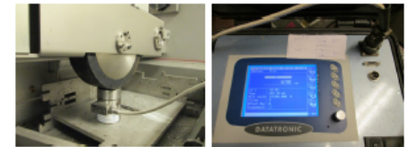
Figur 10: Kalibrering av belastning.
