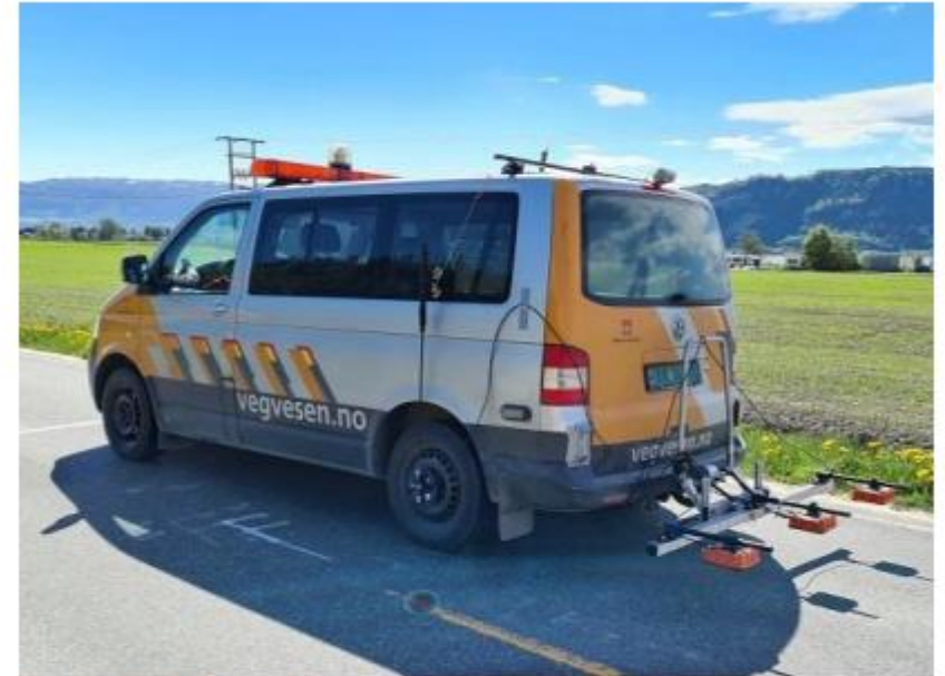
Figur 2.3.7-1: Georadar montert bak på bilen
