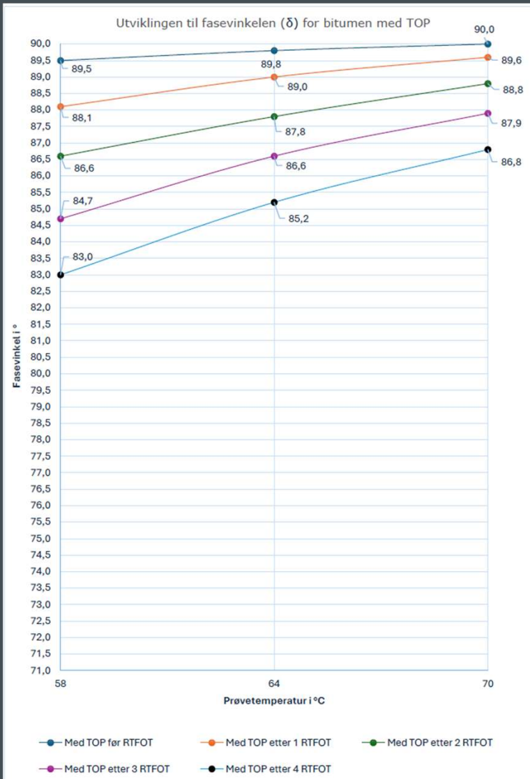
Figur 11. Utviklingen til fasevinkelen for bitumen substituert med 25% TOP.
