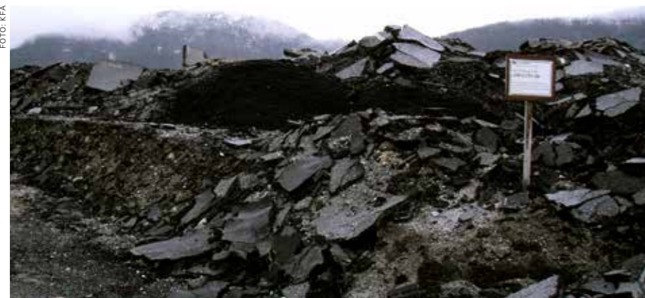
KFA ble opprettet i 2001 og satte gjenbruk og resirkulering av asfalt på dagsorden. Her et bilde av returasfalt på mellomlager.
