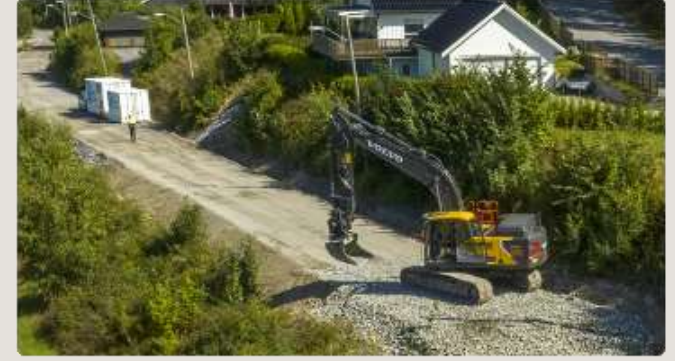
Mobile ladestasjoner for elektriske anleggsmaskiner
