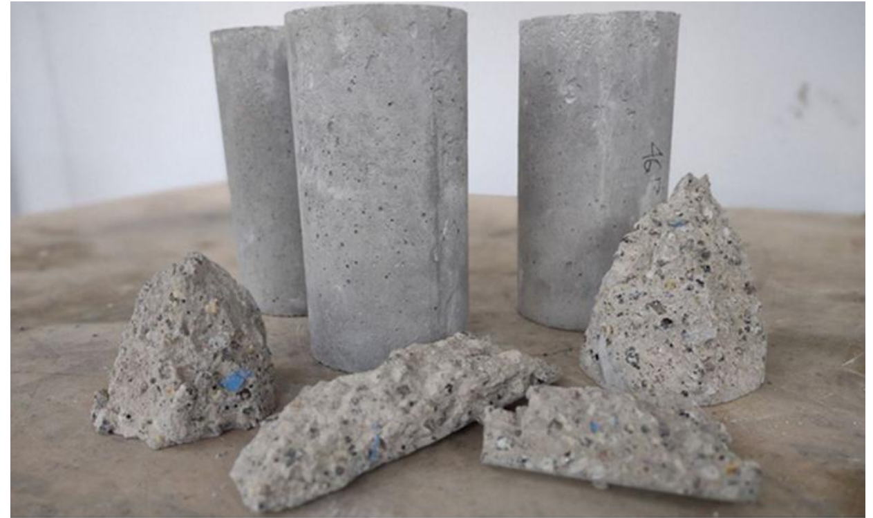
Munnbind og engangshansker kan styrke betong, skriver australske forskere. Foto: RMIT University
