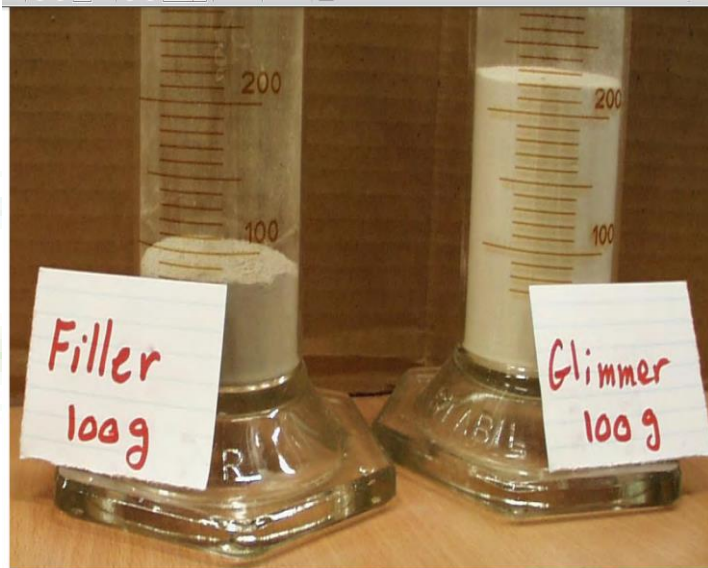
Volumforskjell på 100 g filler fra Skaarlunda (65 % feltspat 25 % kvarts 10 % glimmer) og 100 g glimmer (kinesisk muskovitt)
